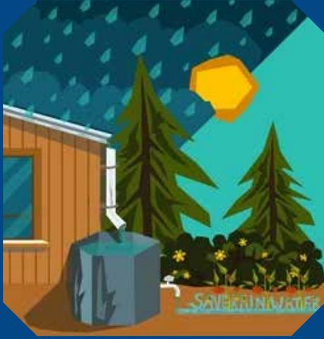
Captación de agua de lluvia. Permite diferentes usos no potables, como limpieza, sanitarios y riego. Se puede potabilizar luego de un tratamiento adicional.
