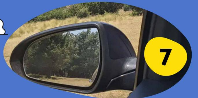
**7.- Posición de los espejos.** Una vez este identificada la correcta posición de manejo, coloca ambos espejos de forma que justo en la parte central de cada uno se pueda observar la esquina trasera del auto en ambos lados.
