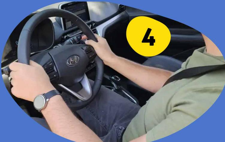
**4.- Posición del volante.** Los codos deben quedar ligeramente flexionados al poner las manos en la parte superior del volante entre las 9 y las 3 del reloj colocando los pulgares fuera del aro.
