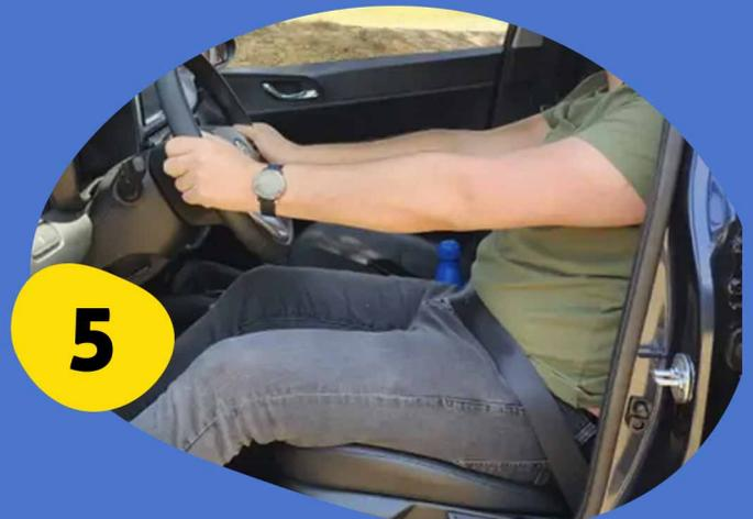
**5.- Altura del volante.** La altura debe permitir observar el tablero libremente entre el centro y la parte del aro superior del volante.
