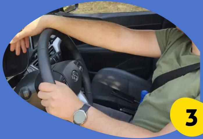
**3.- Inclinación del respaldo.** Mantén contacto de los hombros con el respaldo mientras tocan la parte superior del volante entre las 9 y las 3 del reloj.
